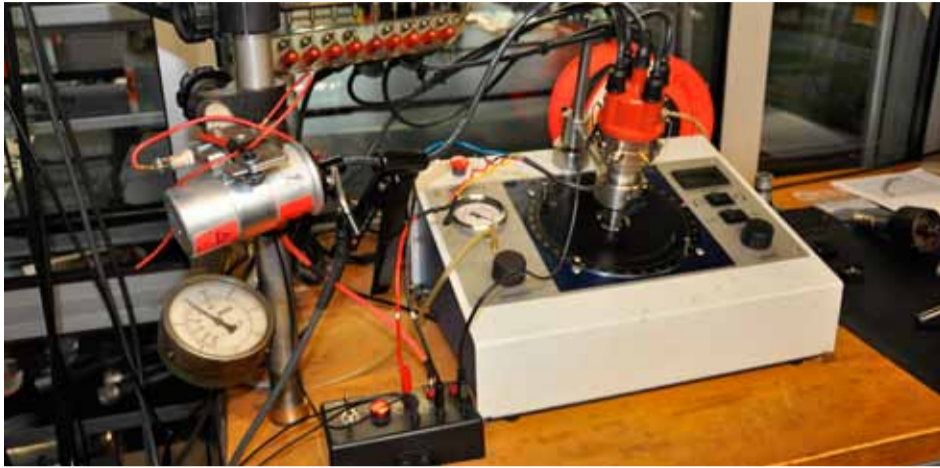
Banc d'essai de contrôle Avec un distributeur d'allumage, quel que soit l'âge de la mécanique inspectée.
